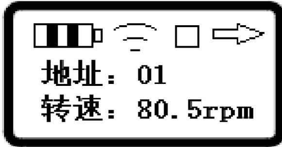
此时界面显示的运行停止状态以及转向，转速均为通过无线模块从远方蠕动泵召唤上来的数据，此时可以操作【增加键】，【减少键】修改转速，还可以短按【启停键】控制蠕动泵启停，短按【全速键】进行全速控制，短按【正反转键】进行方向控制，从而可以起到远方控制蠕动泵的目的；
